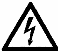
Obr. 7.9.6 Výstražná značka na označenie krytov elektrických zariadení pracovných strojov
